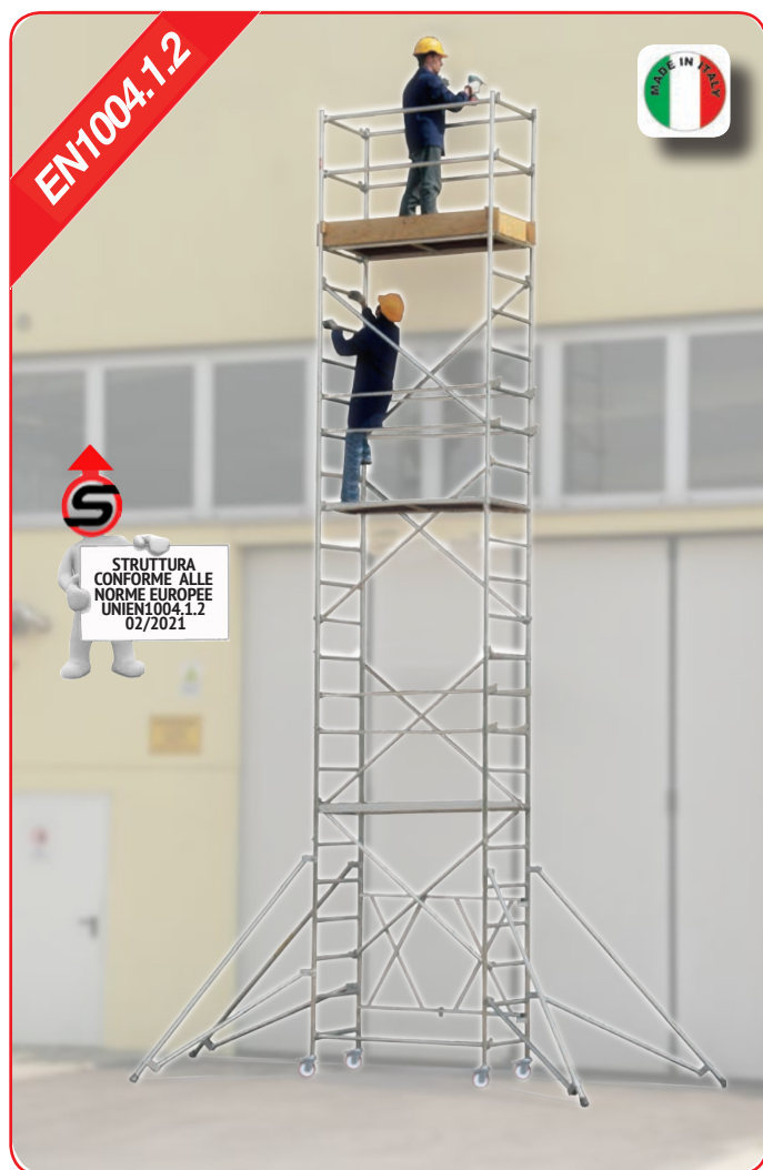
Roller S montato a m 7,10 (moduli A+B+C+E) ingombro base m 1,60x0,80 - Uso interno senza zavorre
