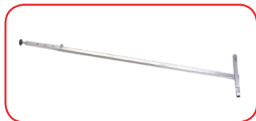
ROMPITRATTA DI BASE (telescopico): in acciaio zincato, obbligatorio per altezze superiori a 8 m Peso Kg 7,60 Chiuso cm 270 - sfilato cm 490
